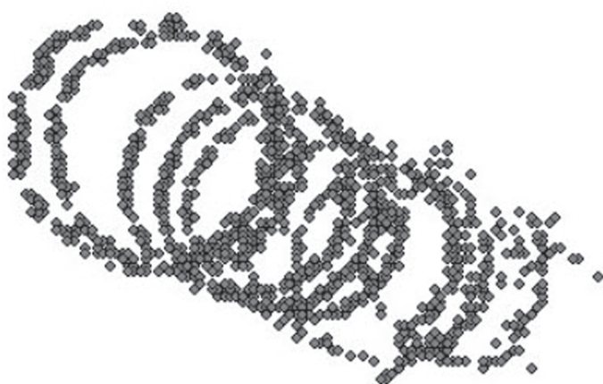
Rys. 2. Przykład wykorzystania kolejnych wycinków pnia w procesie detekcji pojedynczego drzewa w chmurze punktów TLS na powierzchni kołowej numer 10 w Nadleśnictwie Milicz
