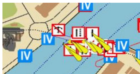
Rysunek 7. Dane przetworzone zgodnie z algorytmem dla skali 1:2000, przedstawione w geokompozycji składowej 1:5000 (obraz powiększony, aby ułatwić ocenę)
