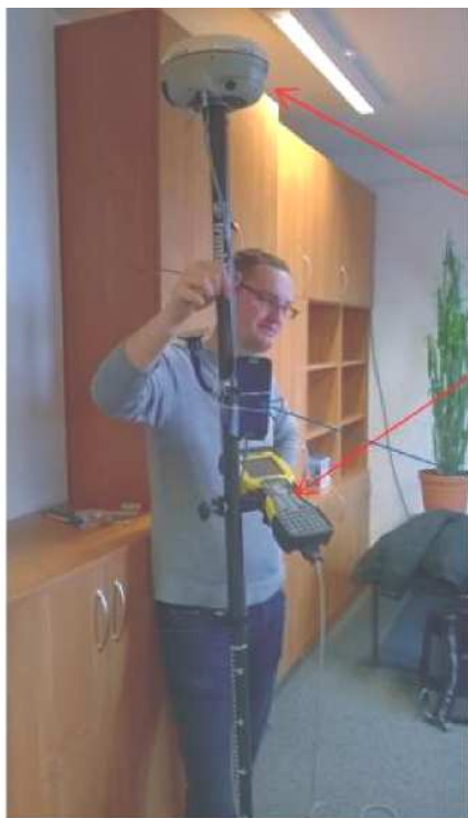
Rysunek 5. Zestaw pomiarowy do testowania różnic między urządzeniem mobilnym a wskazaniami GNSS/RTK (opracowanie własne)
