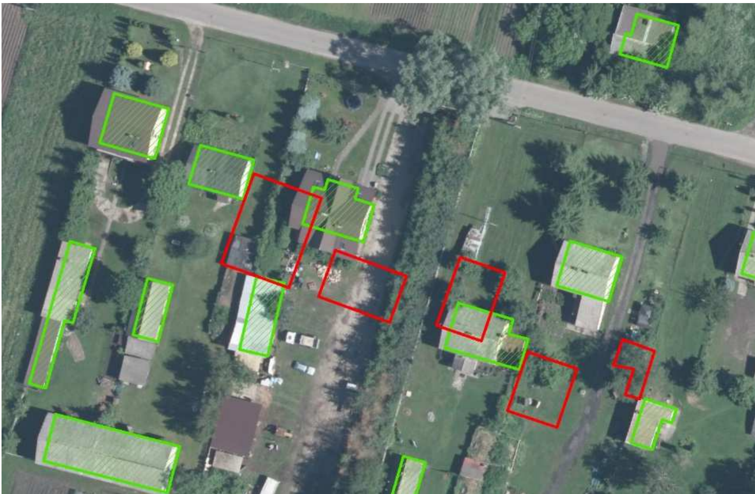
Rysunek 1. Błędna identyfikacja i lokalizacja budynków w bazie OSM (kolor czerwony); kolorem zielonym zaznaczono budynki pochodzące z BDOT10k
