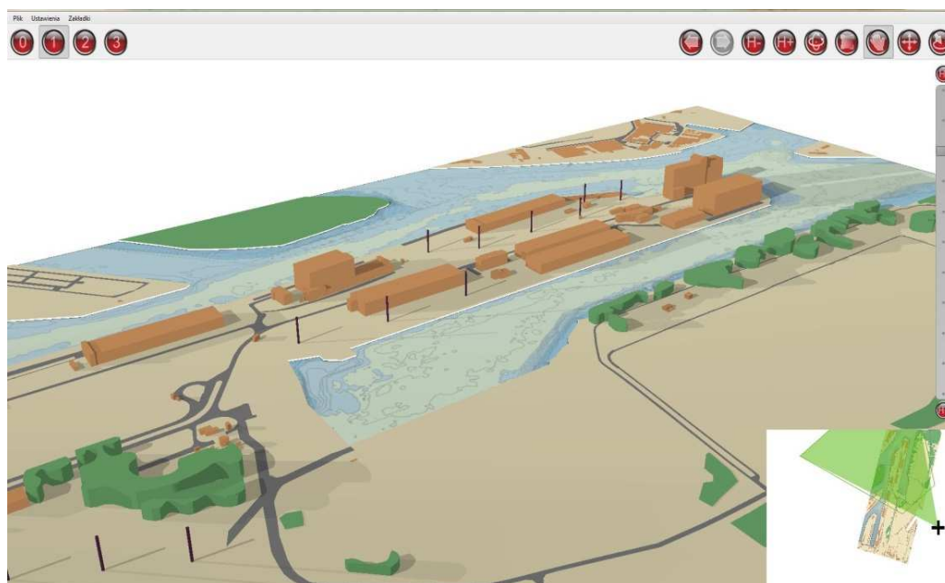
Rysunek 4. Geo3D – aplikacja do wizualizacji mapy 3D; główne elementy to uproszczony interfejs, składający się z: – panelu do wizualizacji mapy, – paska narzędziowego znajdującego się w jego górnej części (przyciski wyboru poziomu szczegółowości mapy oraz narzędzia nawigacyjne); dodatkowym elementem była wizualizacja sektora obserwacji z obranego przez operatora punktu w postaci poglądowej mapki lokalizacyjnej (prawy dolny róg interfejsu)
