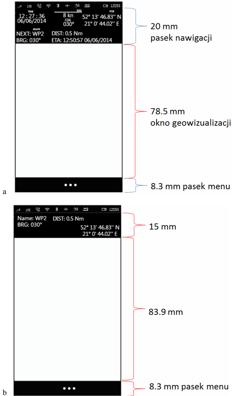
Rysunek 2. Przykład okien geowizualizacji w trybie: a – nawigacji, b – planowania trasy (opracowanie własne)
