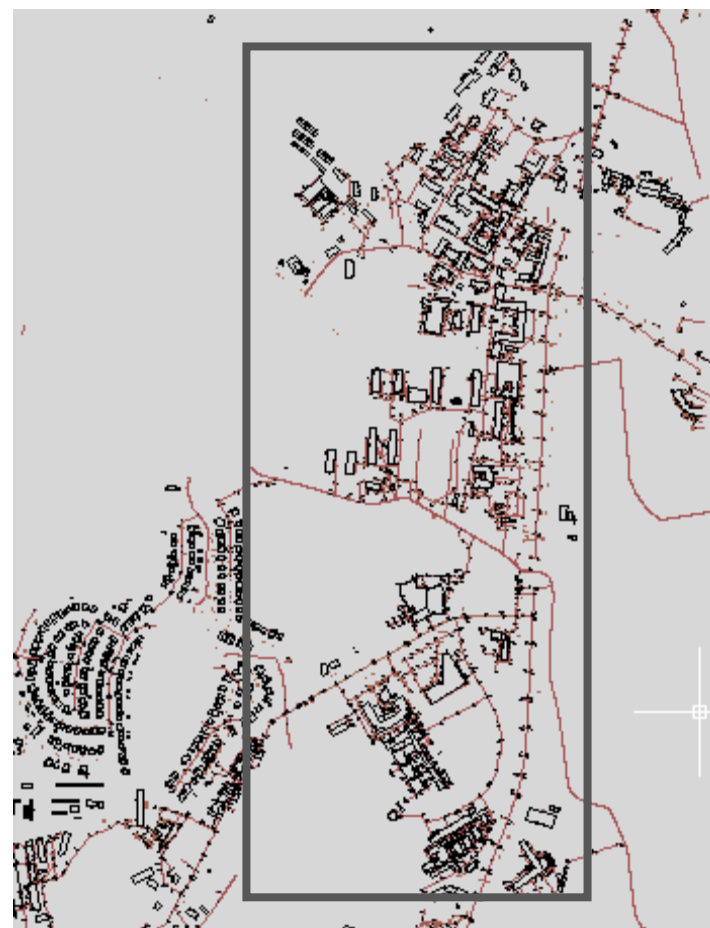
Rysunek 3. Obszar opracowania, dane wyjściowe do przeprowadzenia eksperymentu, widok przebiegu sieci kanalizacji deszczowej: a – samej sieci, b – sieci z widoczną lokalizacją budynków
