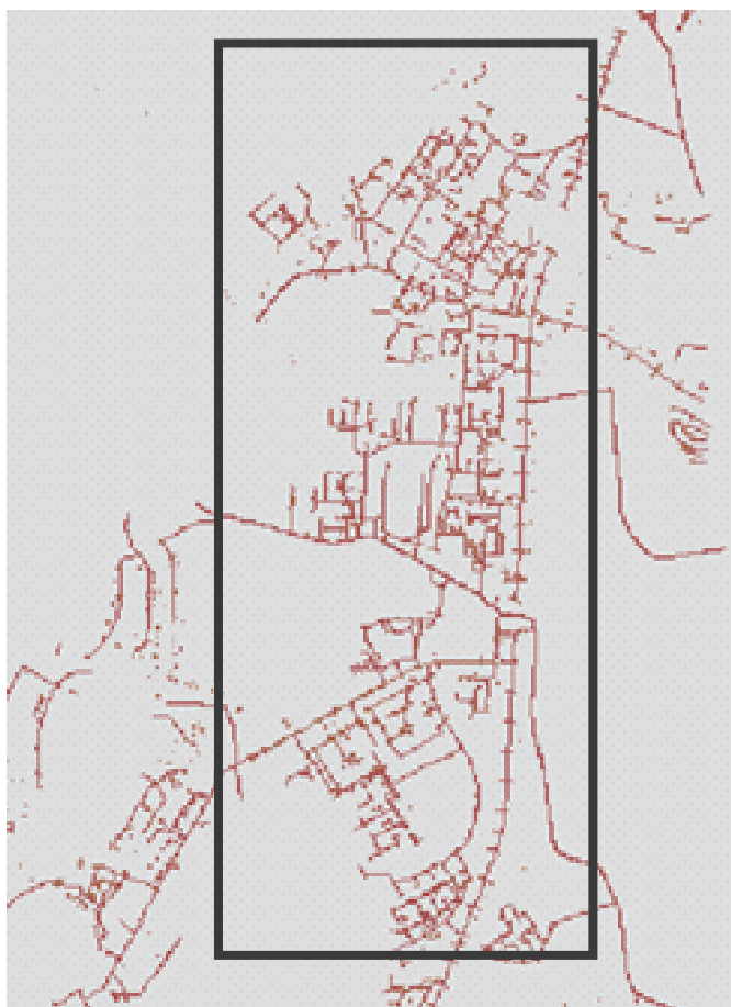
Rysunek 3. Obszar opracowania, dane wyjściowe do przeprowadzenia eksperymentu, widok przebiegu sieci kanalizacji deszczowej: a – samej sieci, b – sieci z widoczną lokalizacją budynków
