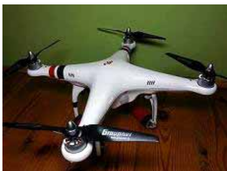
Rysunek 1. Wielowirnikowiec DJI Phantom (fot. P. Szymański)
