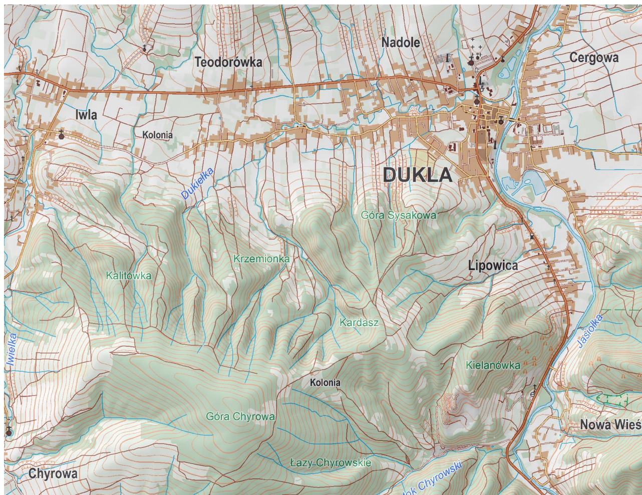
Rys. 2. Fragment mapy topograficznej zredagowanej na podstawie BDOT w skali 1:50 000 z dodatkową warstwą cieniowania rzeźby terenu (opracowanie: P.J. Kowalski, R. Olszewski)
