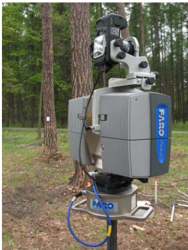
Rys. 3. Skaner FARO PHOTON 80 ze zintegrowaną kamerą cyfrową Nikon
