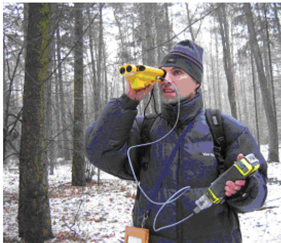
Rys. 1. Praca z LaserAce 300 – dane są wprowadzane bezpośrednio do rejestratora (fot. M. Brach)
