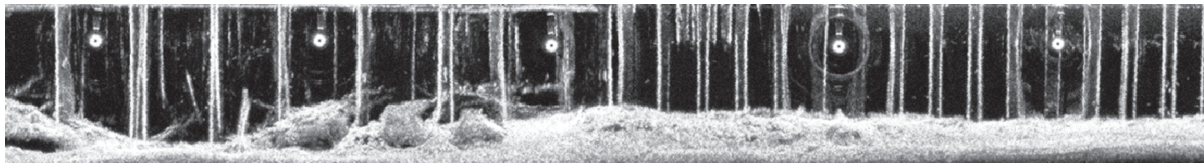
Rys. 4. Skan stanu nabrzeża Drab I w porcie Szczecin; sonar MS1000 675kHz
