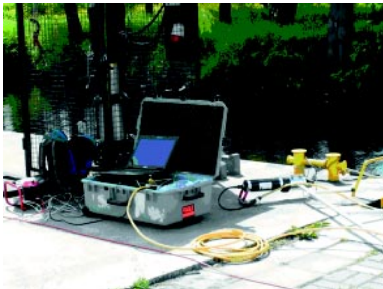
Rys. 1. Stanowisko pomiarowe sonaru skanującego MS 1000 (opracowanie własne)
