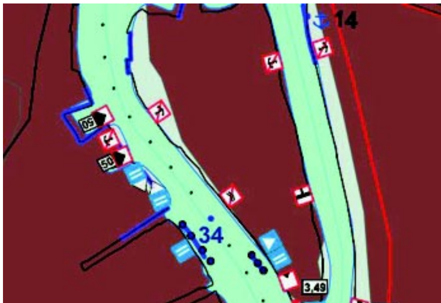
Rys. 6. Znaki żeglugowe na Odrze zachodniej i Parnicy (źródło: Kreft i in., 2009)
