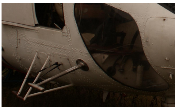
Rys. 4. Miejsce montażu na helikopterze: a – anteny GPS, b – anteny modemu radiowego
