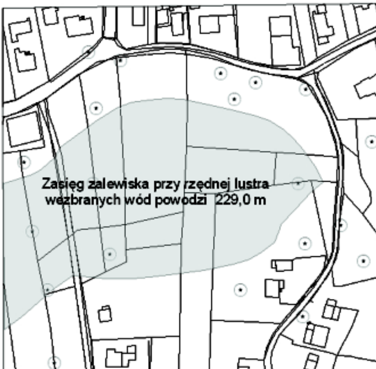
Rys. 1. Fragment tradycyjnej mapy wielkoskalowej z naniesioną warstwicą zalewiska.
