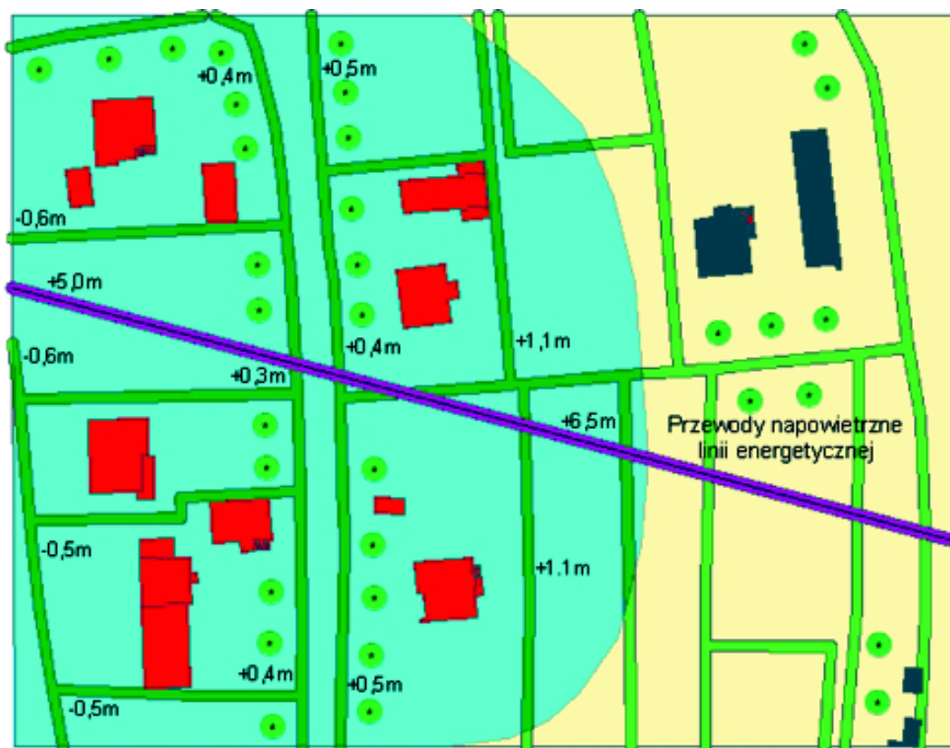
Rys. 4. Mapa przeszkód podwodnych i nadwodnych dla akcji ratowniczej prowadzonej za pomocą sprzętu pływającego. W wyniku analizy w systemie ArcGIS 9 firmy ESRI uzyskano lokalne wysokości przeszkód wystających ponad powierzchnię fali zalewowej (liczby ze znakiem plus) oraz głębokości posadowienia przeszkód podwodnych względem tej powierzchni (liczby ze znakiem minus). Dla wzmocnienia kreskowego rysunku przeszkód wykonano bufor ogrodzeń o promieniu 1 metra
