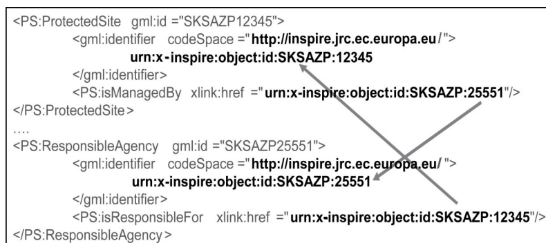
Rys. 2.8. Przykład wzajemnego wiązania elementów zapisu danych w języku GML z wykorzystaniem wbudowanego w ten język mechanizmu xlink:href – jednego z wielu rozszerzeń XML.
