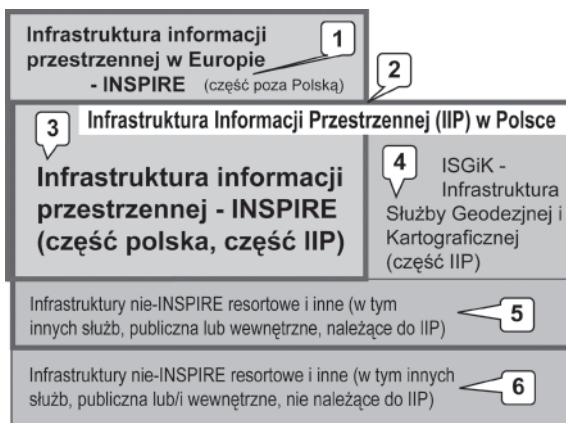
Rys. 4. Główne części polskiej infrastruktury geoinformacyjnej, której schemat architektury jest przedstawiony na rysunku 2. Całość składa się z czterech stref (prostokątnych obszarów), w tym jeden, dotyczący IIP (2 – szara gruba ramka), częściowo nakłada się na pozostałe strefy (3, 4 i 5)
