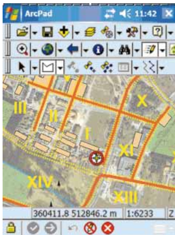
Rys. 6. Orientacja topograficzna w pierwszym sektorze pomiarowym na podstawie wyznaczenia przez GPS lokalizacji kartującego
