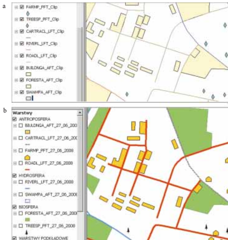
Rys. 3. Porównanie układu warstw i grafiki znaków na mapie (skala 1:15 000): a – przed uporządkowaniem, b – widok po pogrupowaniu warstw według sfer środowiska przyrodniczego i symbolizacji według zasad kartograficznych
