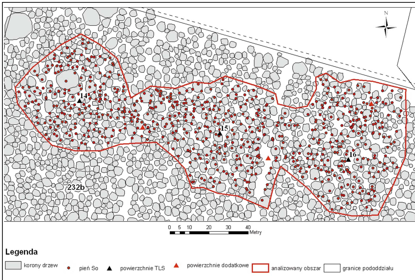
Rys. 8. Lokalizacja pni drzew z pomiaru PosTex na tle korondzew (ALS +trueorto TopoSys) w wydzielaniu 232b (Nadleśnictwo Milicz)
