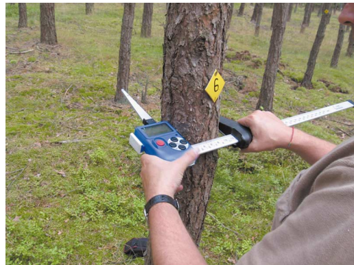
Rys. 4. Pomiar pierśnicy średnicomierzem DigiTech Professional Calliper
