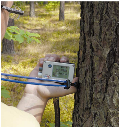
Rys. 5. Użycie wysokościomierza VERTEX IV jako dalmierza w zestawie PosTex
