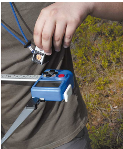
Rys. 6. Transmisja danych: odległość i wysokość z VERTEX IV do rejestratora DigiTech (IrDA)
