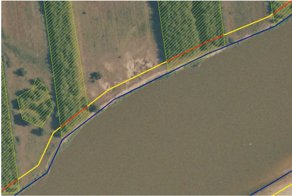
Rys. 5. Wynik analizy pokrycia brzegu rzeki: a – wizualizacja (jasne fragmenty linii – brzeg nie zarośnięty, ciemne – pokryty przez lasy lub zadrzewienia); b – długość linii brzegowej (obie strony) 10 320 m, brzeg porośnięty 5020 m, brzeg otwarty 5300 m
