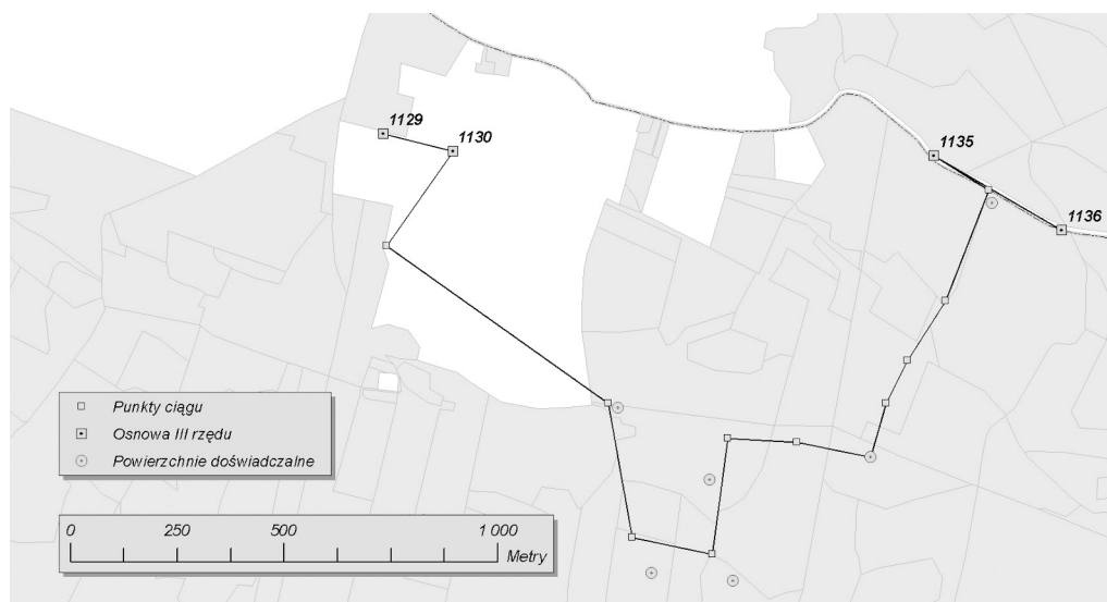
Rys. 6. Szkic sytuacyjny ciągu poligonowego opartego o osnowę III rzędu w Nadleśnictwie Milicz
