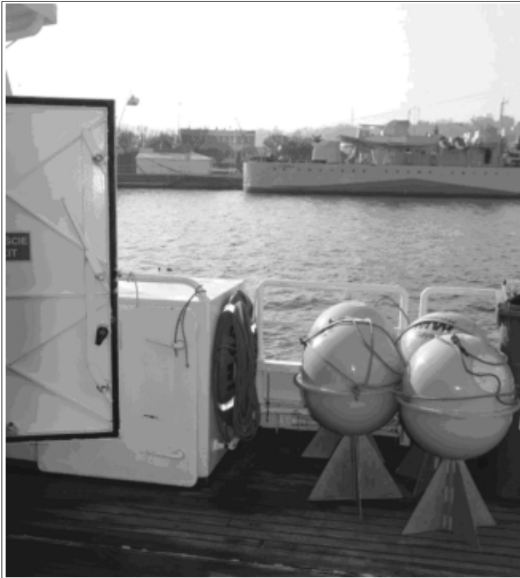
Rys. 5. Dryftery na pokładzie statku badawczego IMOR oraz wystawianie dryfterów do pomiarów
