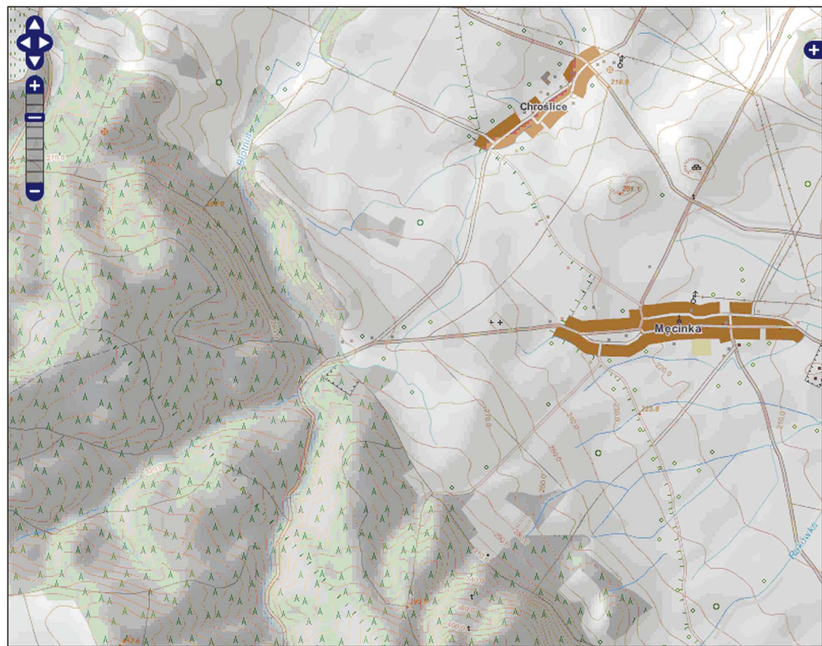
Rys. 3. Wizualizacja danych VMap L2u z nałożonym cieniowanym obrazem rzeźby terenu z modelu DTED2
