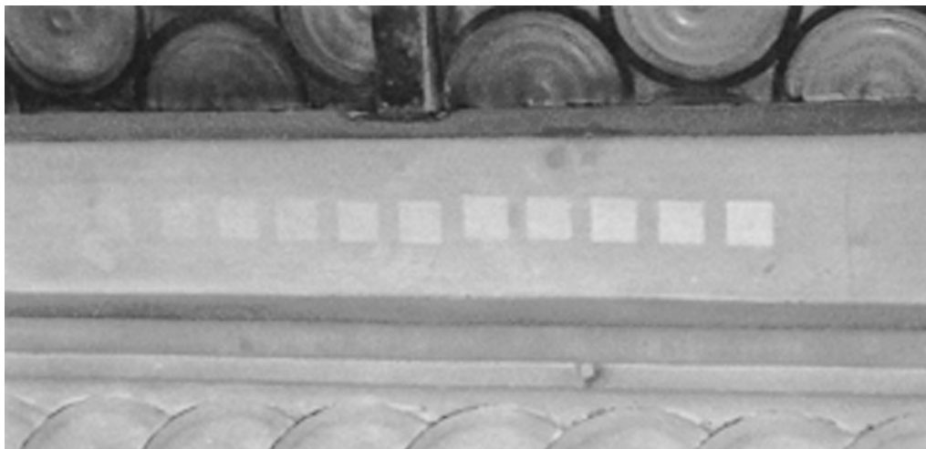
Rys. 4. Ilustracja wpływu gęstości energii na grubość usuwanego nawarstwienia z piaskowca szydlowieckiego latarni Kaplicy Zygmuntowskiej. Widoczne etapy usuwania kolejnych warstw nawarstwienia.
