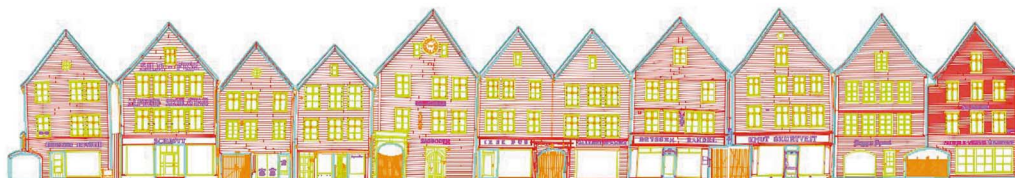
Rys. 7. Elewacja drewnianej zabudowy portowej w Bergen w rzucie prostokątnym – pomiary czternastej wyprawy studentów AGH w 2001 roku, skala rysunków dokumentacji oryginalnej 1:50 (opracowanie graficzne – GeoPomiar, Katowice, 2001 r.)
