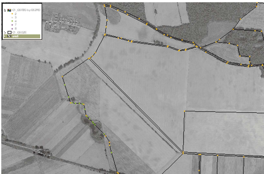
Rys. 13 i 14. W wyniku błędnej kalibracji rastra mapy ewidencyjnej granice działek w pobliżu granicy obrębu zostały przesunięte o ok. 35 m
