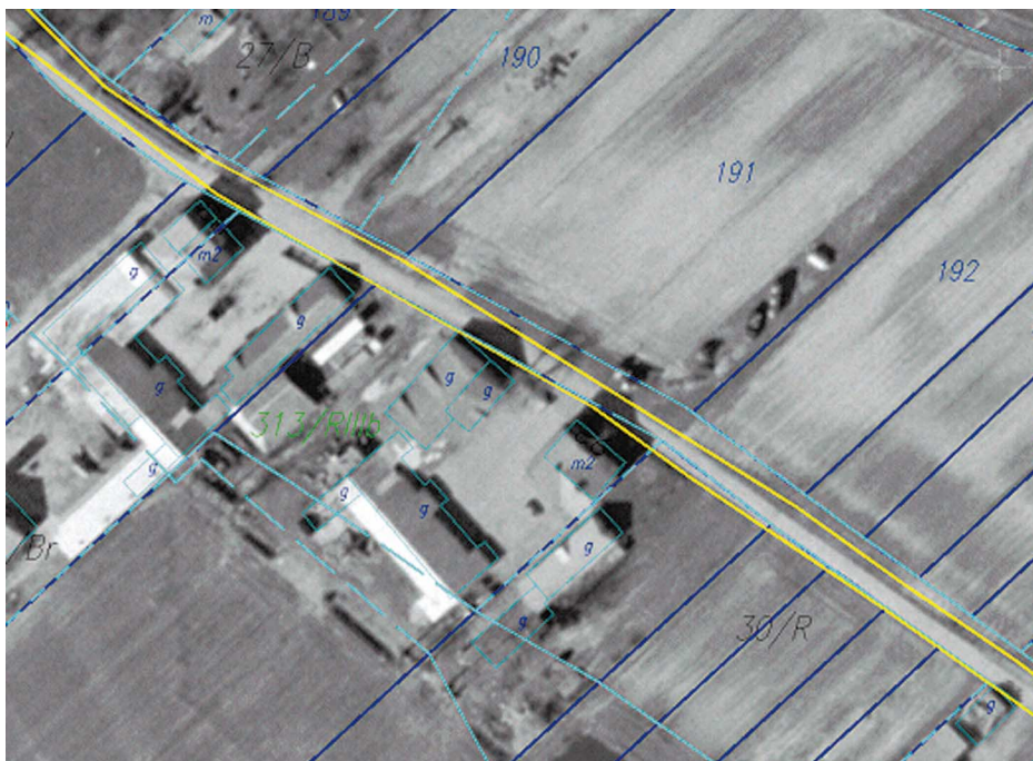
Rys. 17. Przykład niepoprawnej redakcji przebiegu konturu drogi; oznaczenia kolorów: niebieski – granice działek z projektu LPIS, błękitny – kontury użytków gruntowych z projektu LPIS, żółty – dane z pomiaru przebiegu granicy obrębu (MPG Łódź, 2006–2007)
