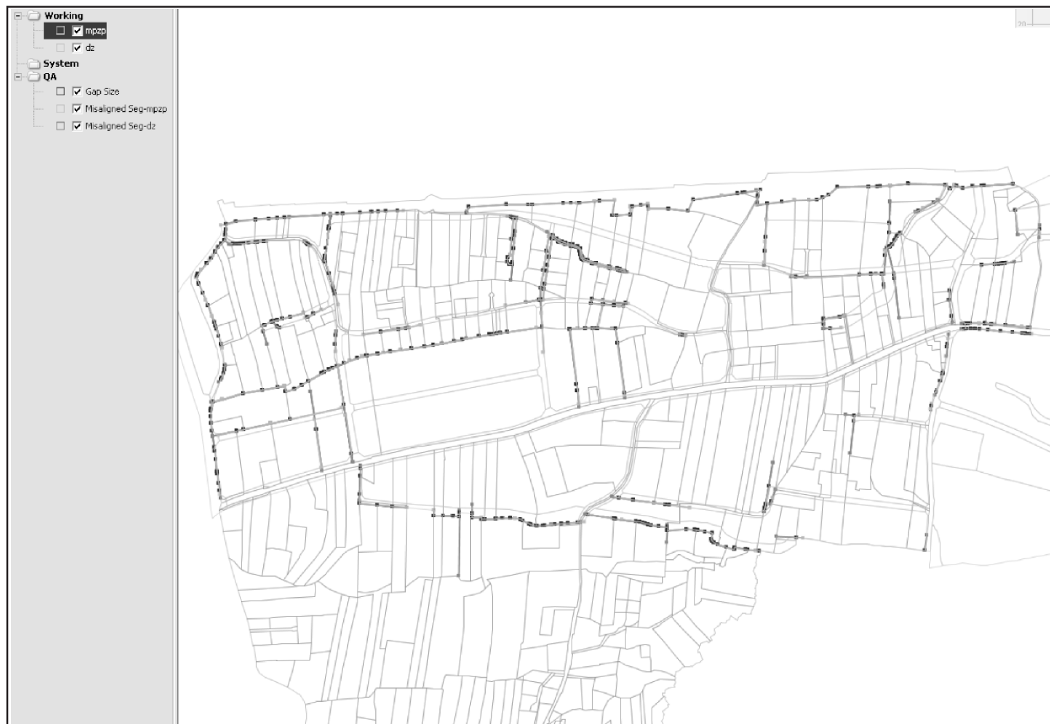
Rys. 3. Wykryte błędy niezgodności przebiegu granic działek i stref planu zagospodarowania przestrzennego na obszarze jednego obrębu ewidencji gruntów
