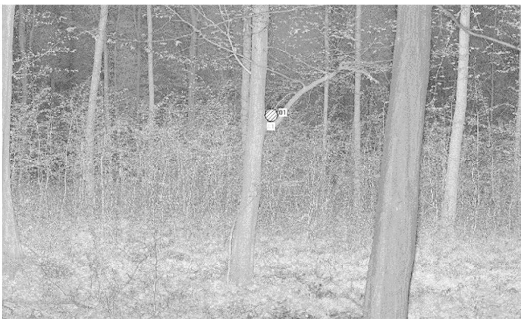
Rys. 2. Obraz tej samej powierzchni utworzony z chmury punktów zarejestrowanych przez skaner laserowy (źródło: FARO)
