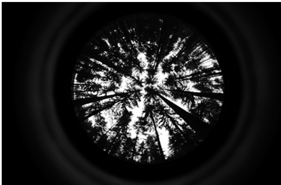
Rys. 2. Zdjęcie hemisferyczne w drzewostanie świerkowym, wykonane zestawem Canon EOS 20D + Canon EF 18-55/3,5-5,6+ konwerter Raynox DCR-CF 185PRO (maksymalny rzeczywisty kat widzenia 185^\circ ); fot. P. Strzeziński
