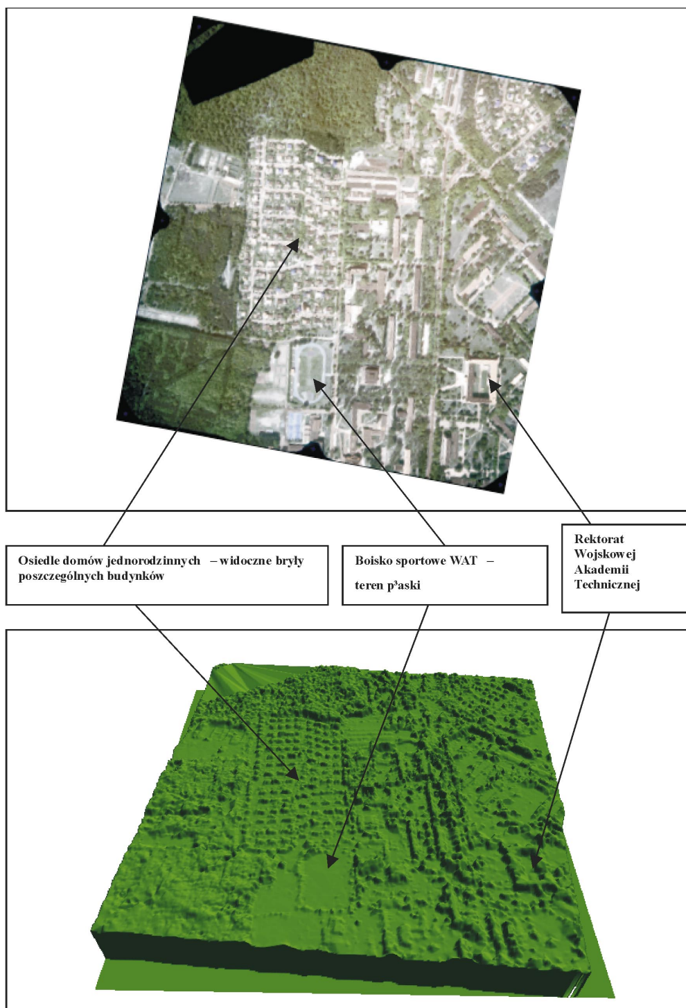
Rys. 2. Numeryczny model powierzchni terenu (NMPT) wykonany z przetworzonych zdjęć lotniczych (Warszawa Bemowo – miasteczko akademickie WAT) z wykorzystaniem modułu LPS pakietu ERDAS (wizualizacja VirtualGIS)
