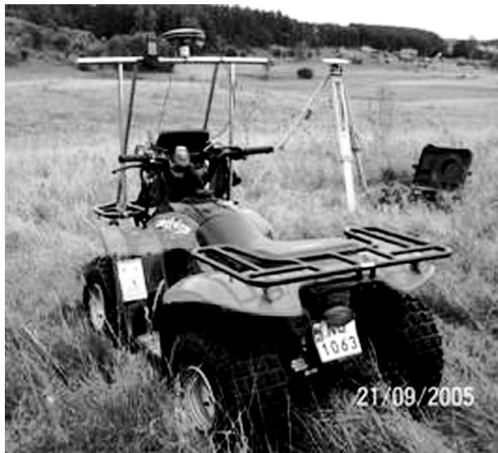
Rys. 2. Pojazd czterokołowy z zamocowanymi odbiornikami geodezyjnymi i nawigacyjnymi
