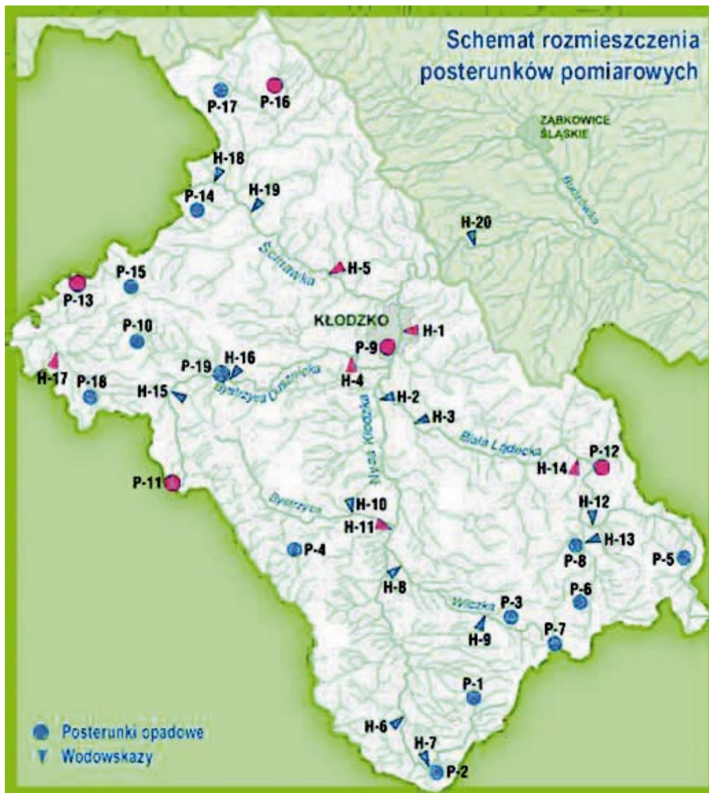
Rys. 1. Schemat rozmieszczenia posterunków pomiarowych Lokalnego Systemu Osłony Przeciwpowodzowej Powiatu Kłodzkiego (źródło: http://www.lsop.powiat.klodzko.pl )
