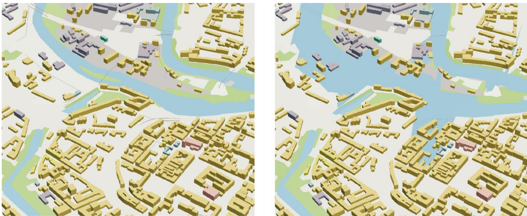
Rys. 3. Przybliżone obliczenie i wizualizacja zasięgu rzeki po podniesieniu poziomu wody o zadaną wartość na podstawie danych zawartych w TBD
