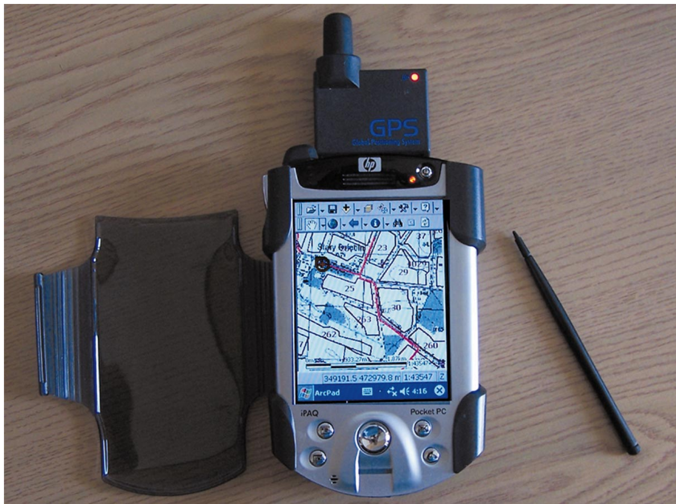
Rys. 3. Palmtop z odbiornikiem GPS wykorzystywany w trakcie badań terenowych. Na monitorze widoczny jest fragment mapy topograficznej, granice zasięgów upraw na polach testowych oraz znacznik aktualnego położenia podawanego przez odbiornik GPS
