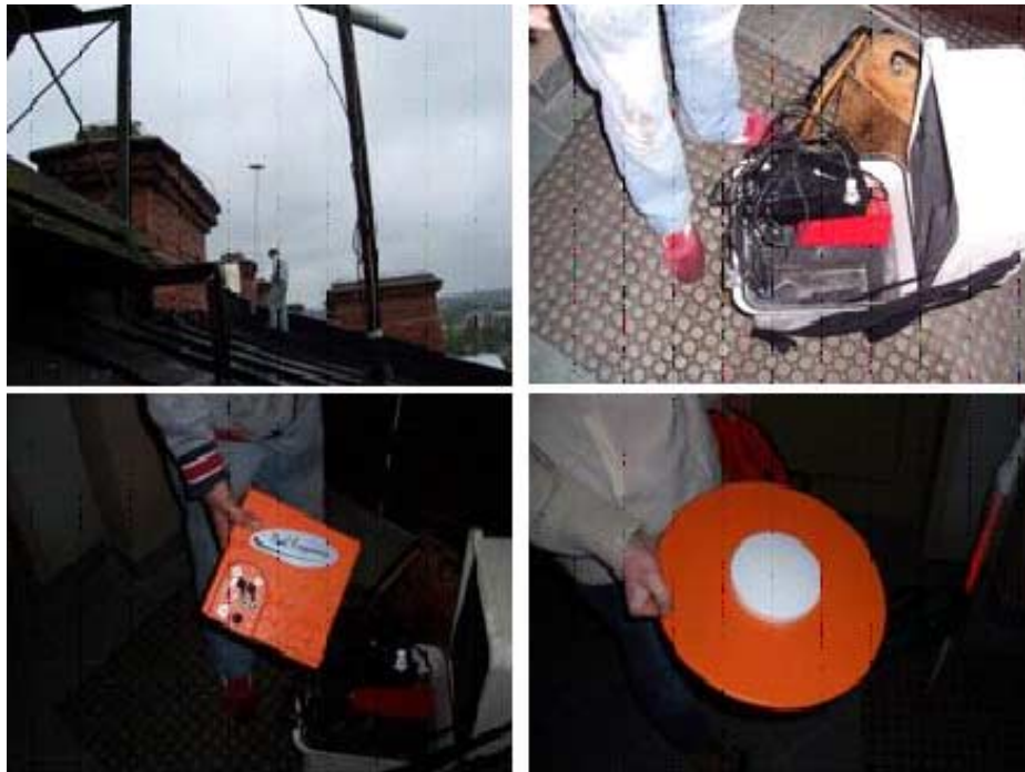
Rys. 6. Dokonywanie pomiarów dostępności sygnałów satelitarnych na dachu PWSZ w Chełmie
