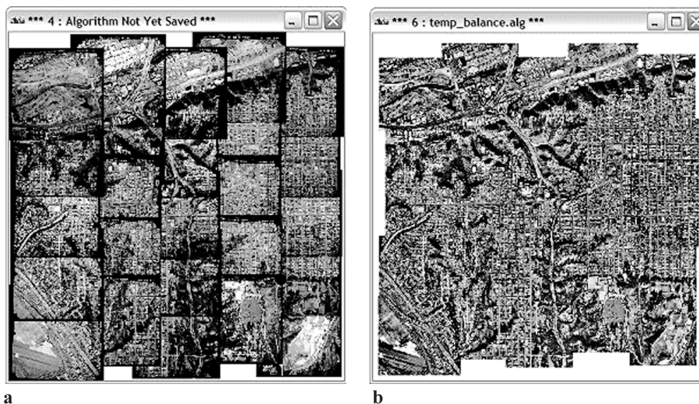
Rys. 12. Mozaika zdjęć lotniczych obszaru San Diego: a – obraz przed użyciem asystenta wyrównania tonalnego, b – obraz wyrównany tonalnie i pozbawiony elementów ramek
