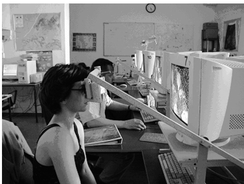
Rys. 1. Komputery w pracowni przekształcone w cyfrowe stacje fotogrametryczne VSD-AGH
