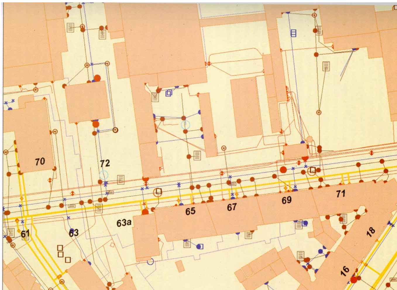
Rys. 2. Obraz sieci uzbrojenia na monitorze, skala 1 : 1000
