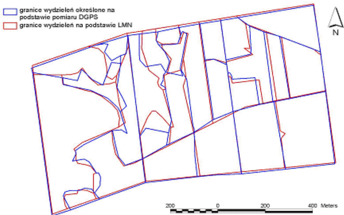
Rys. 1. Porównanie przebiegu granic wyłączeń w drzewostanach wyznaczonych na podstawie pomiarów DGPS z wektorami LMN wybranych oddziałów Nadleśnictwa Niepołomice (RDLP Kraków).
