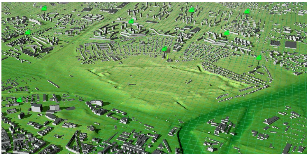
Rys. 5. Siatka testowa o wymiarach pola podstawowego 100×100 m
