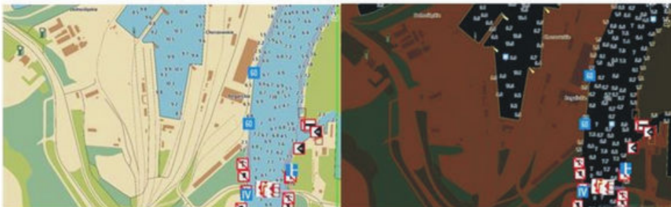
Rysunek 3. Schematy kolorów aplikacji MOBINA: schemat nr 1 – styl Inland ECDIS, schemat nr 2 – styl MOBI (opracowanie własne)
