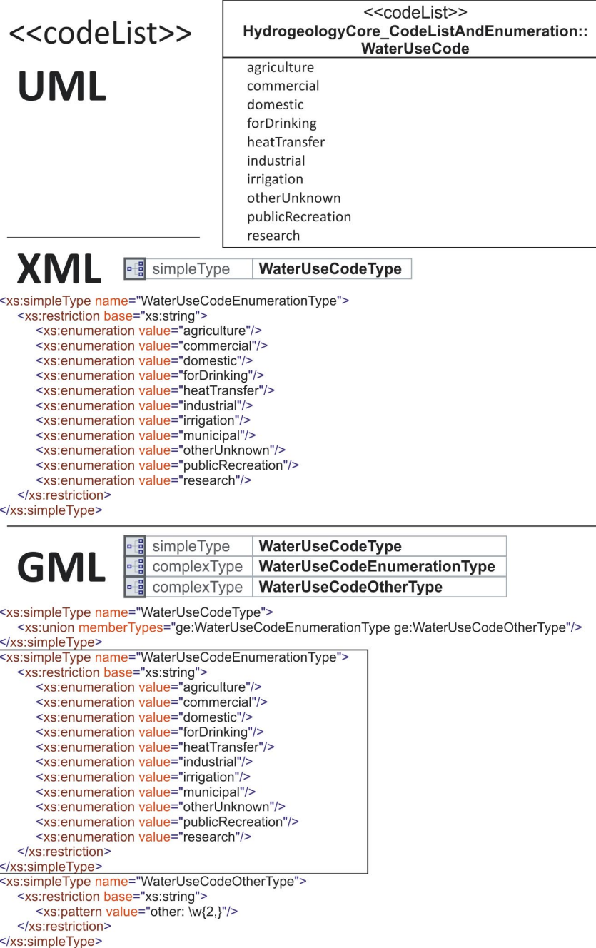
Rys. 4. Transformacja UML – XML – GML klasy ze stereotypem <<CodeList>> na przykładzie WaterUseCode
