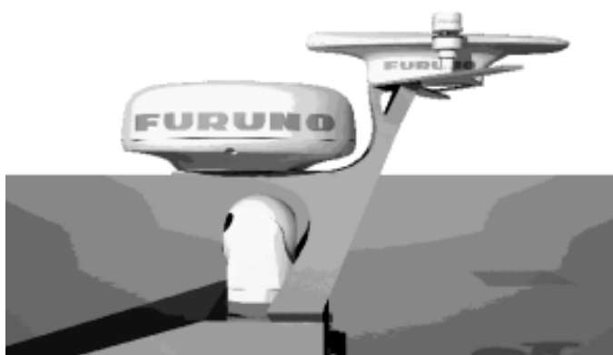
Rys. 2. Projekt masztu z rozmieszczeniem urządzeń bezzałogowego pojazdu nawodnego
