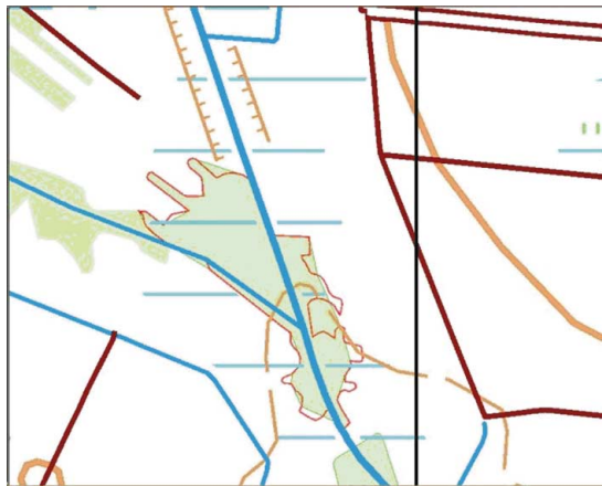
Rys. 3. Wyniki generalizacji konturów obiektów typu zarośla krzewów, kosodrzewina; kontur oryginalny z bazy źródłowej oznaczono linią czerwoną
