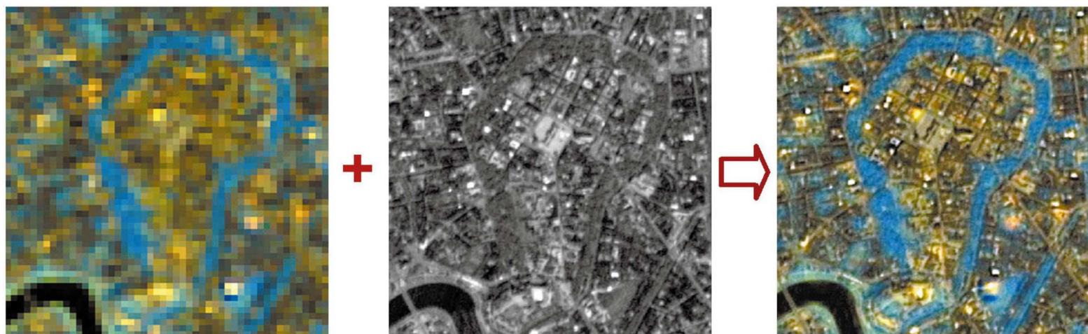
Rys. 4. Wzmocnienie przestrzenne w wyniku integracji obrazu wielospektralnego i obrazu panchromatycznego o wyższej rozdzielczości przestrzennej
