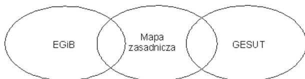
Rys. 4. Schematyczny model baz danych przestrzennych na poziomie powiatu. Bazy zawierają wspólne obiekty odmiennie definiowane w poszczególnych bazach
